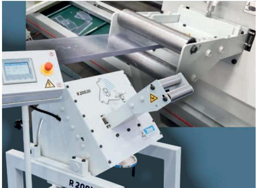
Per Touch-Display lassen sich die Zykluszeiten der mit einem Servo-Getriebemotor ausgestatteten Randbeschnittanlage R 200/20 von Hellweg jetzt frei vorgeben. So lassen sich die Größe und Anzahl der einzelnen Abschnitte unabhängig vom Ausstoß der Extrusionsanlage für die Weiterverarbeitung optimiere (© Hellweg Maschinenbau)
