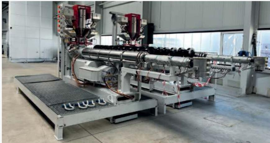
Zentrales Element der Mischanlage: Hochleistungsextruder, ausgestattet mit einer intern entwickelten und gefertigten Plastifiziereinheit für hohe Durchsätze und optimale Verschleißfestigkeit
