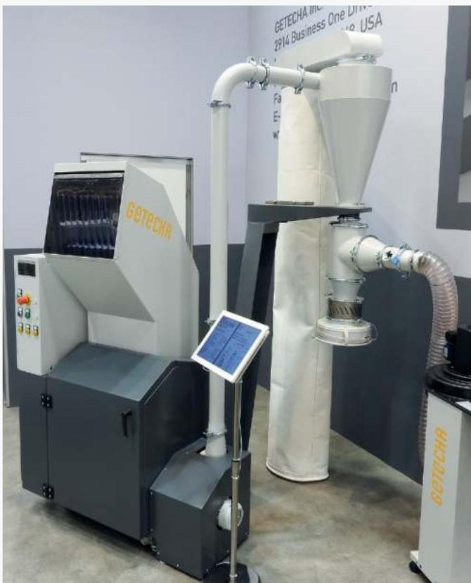
Auf eine stündliche Zerkleinerungsleistung von bis zu 160 kg Material ausgelegt ist die RS 2404 A von GETECHA. Diese kompakte und rollengelagerte Zentralmühle verfügt über einen Mühlenkörper und einen Aufgabetrichter in schallgedämmter Ausführung
