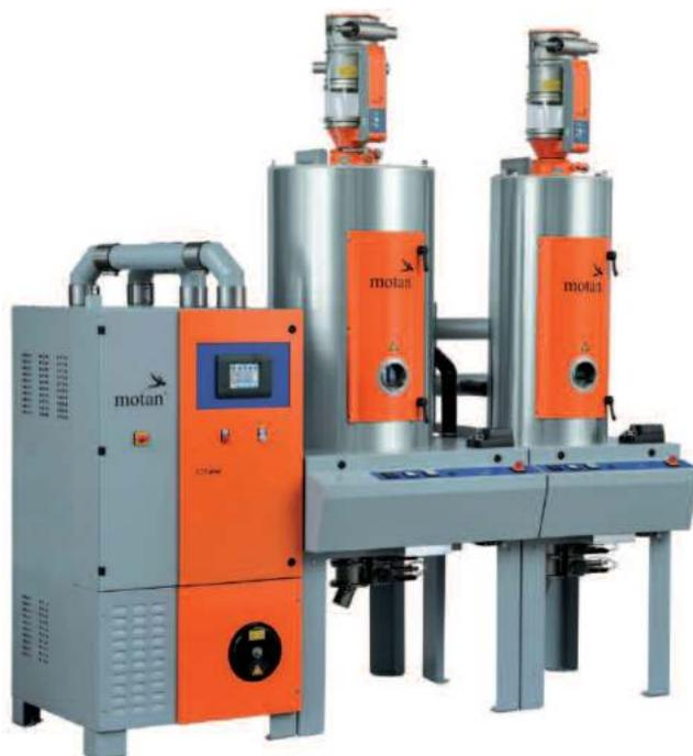
**Trocknungsanlage mit Trockenlufterzeuger (links) und zwei Trockentrichtern (Bild: motan)**
