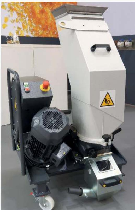
Die Beistellmühle GRS 180 A von GETECHA verfügt über Verschleißschutzplatten im Trichter, so dass sie es im Zusammenspiel mit den verschleißgeschützten Hartmetall-Messern ihres Sieben-Messerrotors auch mit abrasivem Material aufnimmt
