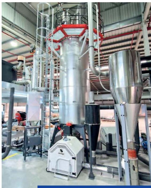
In der Pellet Conditioning Unit erhält das Regranulat den letzten Schliff und wird zu permanent geruchsreduziertem Material
